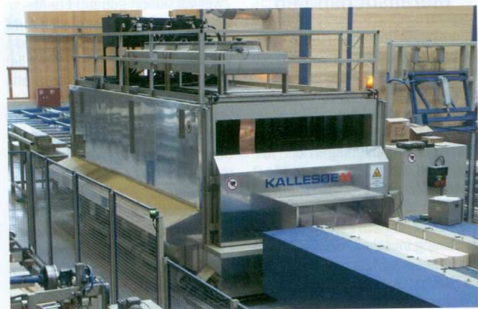
Hochfrequenzpresse von Kallesoe kann auf einer Breite von 1,3 m mit Mehrfach- oder unterschiedlichen Längen befüllt werden
