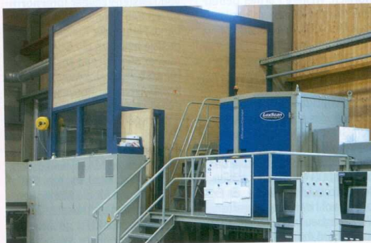
Ein Scanner von Microtec prüft Schnittholz mit Röntgenstrahlen, eine Anlage von Luxscan beurteilt die Hölzer mit optischem Scanner
