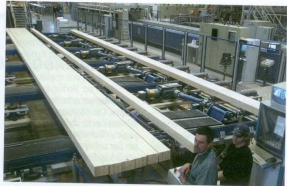
Nach der Auftrennung der verpressten Stangen können diese vor der Hobelmaschine mit Vakuumeinheiten von Minda gewendet werden
