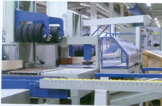
BSH wird mit einer Kappsäge von Minda kommissionsweise abgelängt und mit Barcode versehen
