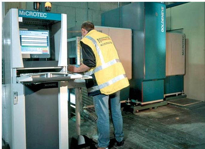
Microtec-GoldenEye im Hobelwerk direkt im Anschluss an die Hobelmaschine installiert
