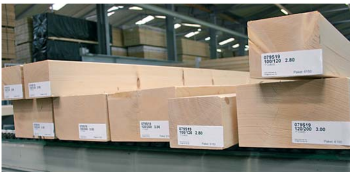
Jedes Stück wird mit genauen Maßen einzeletikettiert und anschließend kommissionsweise foliert
