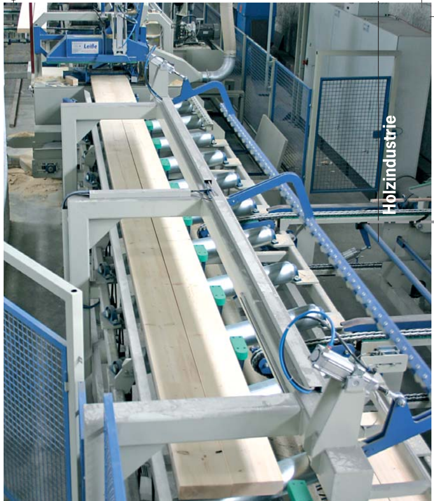
Millimetergenaue Kappung der fertigen Konstruktionsvollhölzer – auch mehrere zeitgleich möglich
