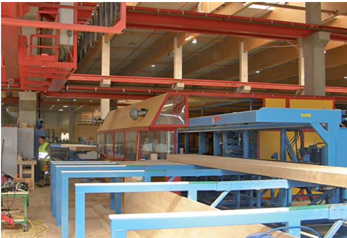
Abbandanlage K3 von Hundegger wurde in die Kommissionierung integriert
