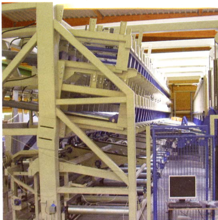
Inbetriebnahme der neuen Presse: diese Ausführung verfügt über zwei Presskammern
